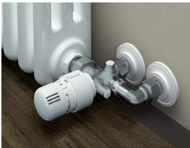
Le valvole mono-bitubo termostattabili ad interasse variabile sono adatte per l'installazione su impianti nuovi ed esistenti. Disponibili con due diversi interassi da 40-50 mm e 48-65 mm e nelle misure da 1/2", 3/4" e 1".
